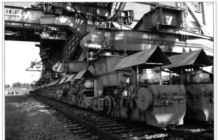
Der Mittelteil der beweglichen Technik-Anlage F 60, von dem die Abraumförderbrücken ausgehen.
